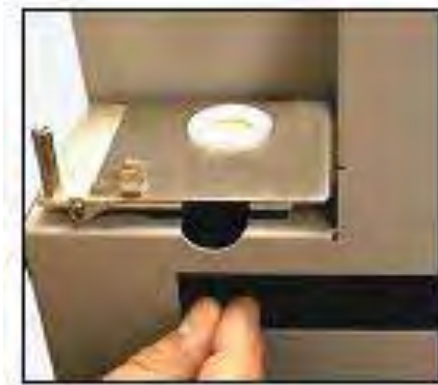
ภาพที่ 18 ช่องสไลด์สำหรับวางผ้า Swab
