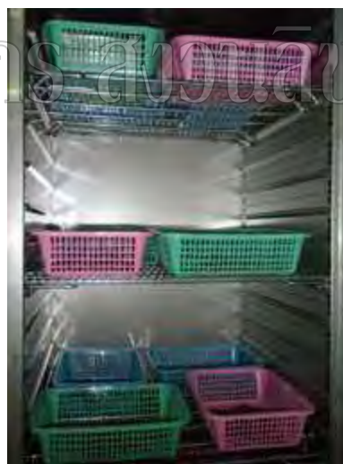
ภาพที่ 22 ภาพแสดงตู้ควบคุมความชื้น Climacel model 404และการจัดเรียงผลิตภัณฑ์ขณะวัด
