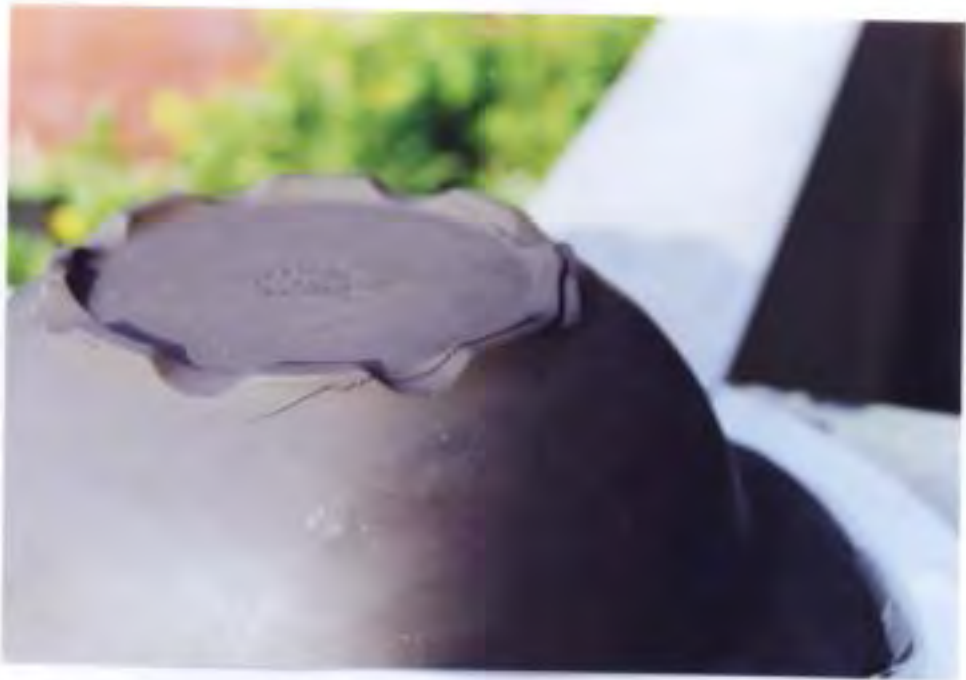
ภาพที่ 40 ปัญหาที่พบขณะถอดพิมพ์ มีการแตกร้าวของชิ้นงาน
