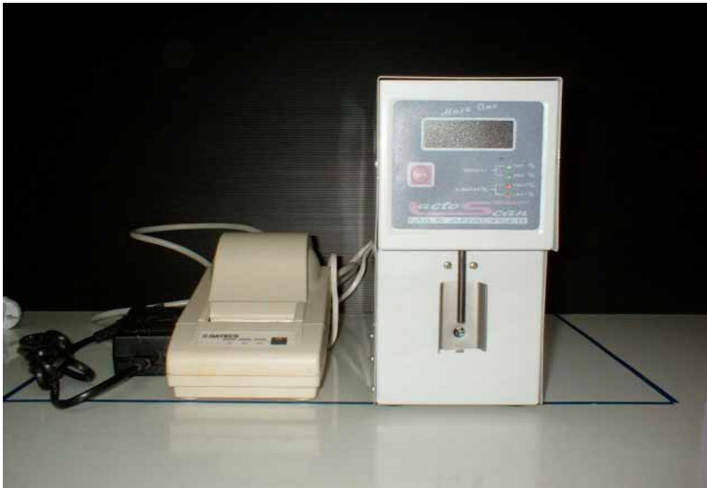
ภาพที่ ข. 3 เครื่องวัดองค์ประกอบของน้ำนม (Milk analyzer)
