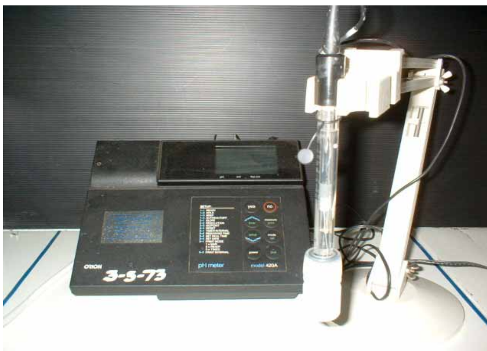
ภาพที่ ข. 2 เครื่องวัดความเป็นกรดต่าง (pH meter)
