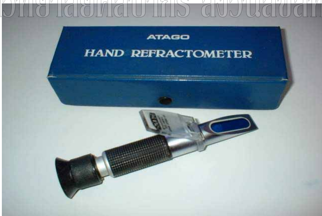
ภาพที่ ข. 4 เครื่องวัดค่าของของแข็งที่ละลายได้ (Hand refractometer)
