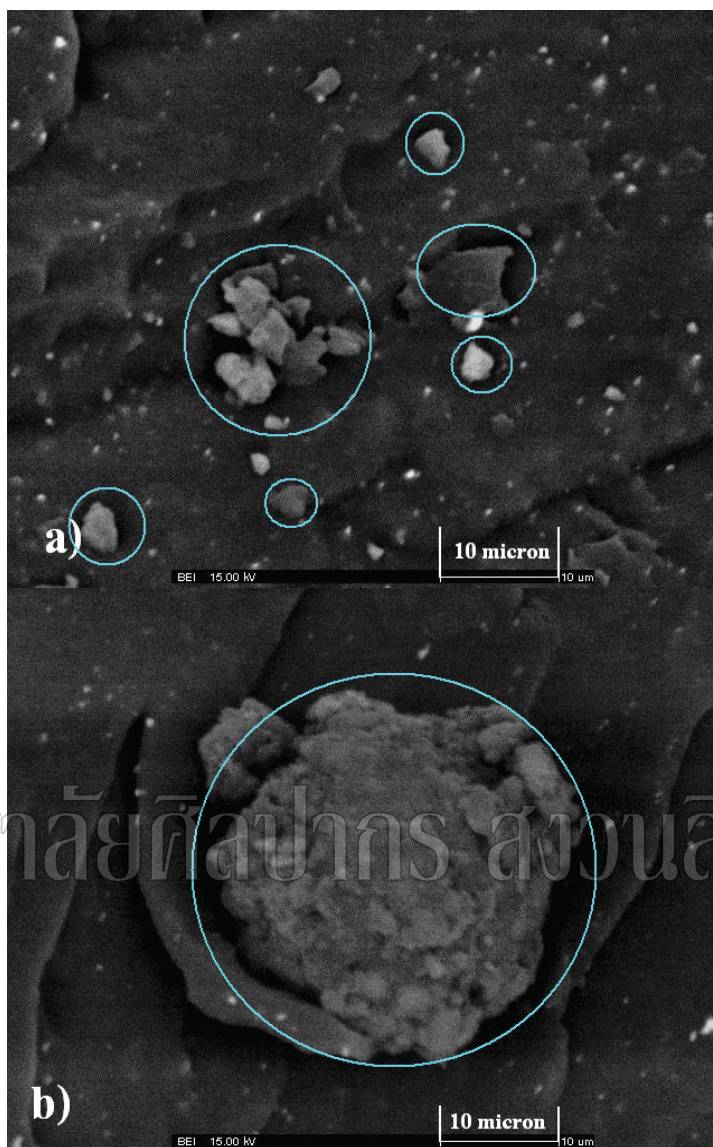
ภาพที่ 37 แสดงภาพถ่ายโครงสร้างจุลภาค ของ a) NR/30PSi และ b) NR/40PSi ที่กำลังขยาย 1000 เท่า บริเวณ Fractured surface
