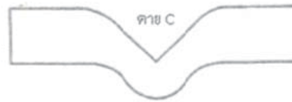
ภาพที่ 19 แสดงชิ้นทดสอบความทนทานต่อการฉีกขาด แบบ C
