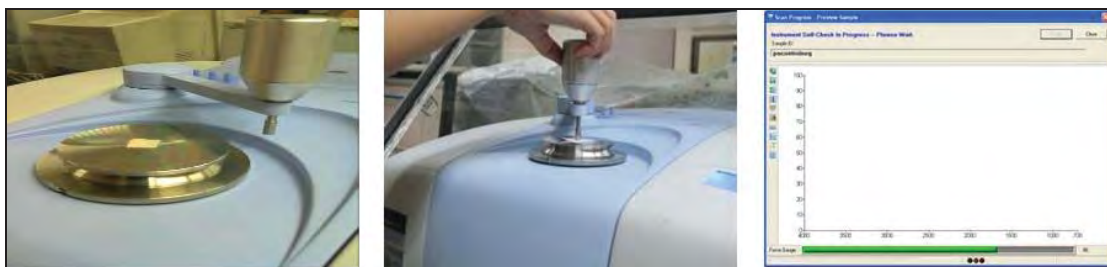
ภาพที่ 10 การวางและหมุนกดตัวอย่าง บนเครื่อง ATR-IR
