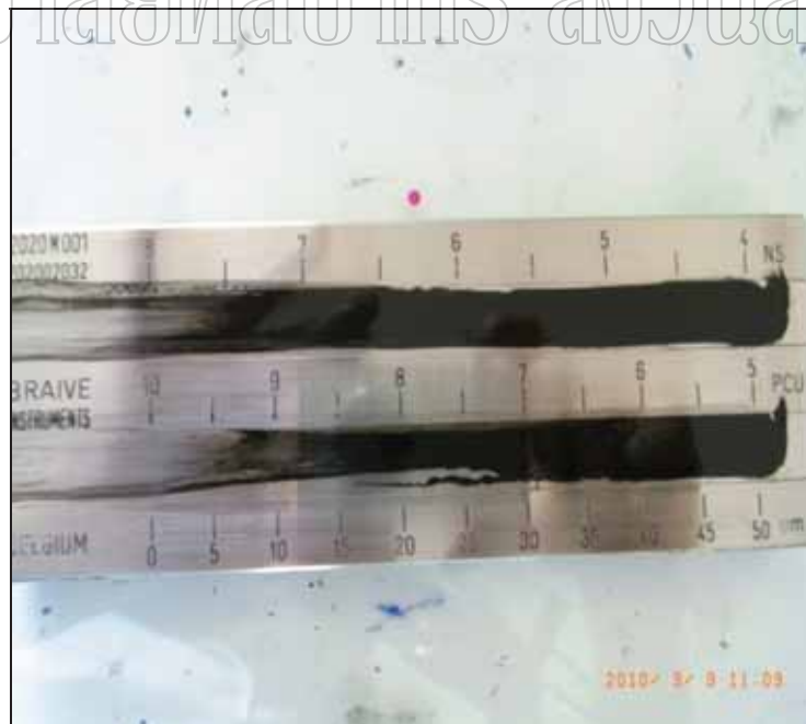
ภาพที่ 30 การกระจายตัวของ graining ค่าที่ได้เป็นบริเวณที่เห็น graining
