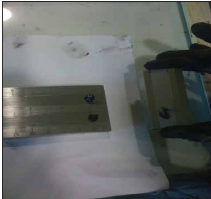
ภาพที่ 29 หยดสารตัวอย่างพอประมาณลงบนร่องด้านลึก (50 ไมครอน)
