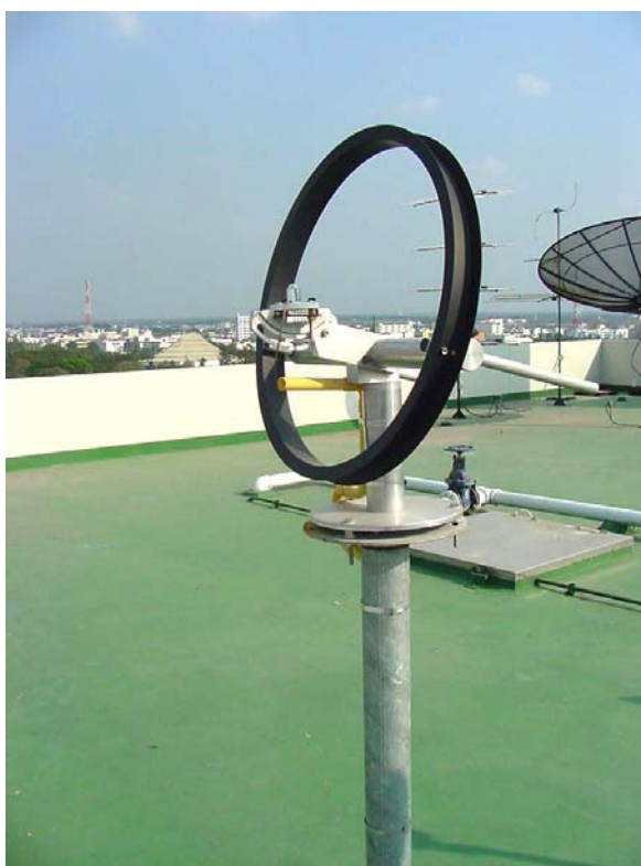
รูปที่ 2.17 แสดงเครื่องวัดแสงสว่างธรรมชาติที่กระจายจากท้องฟ้า
