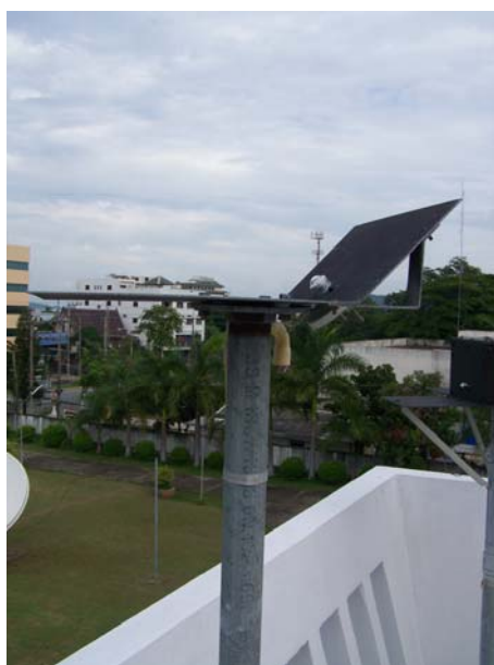
รูปที่ 3.16 แสดงอุปกรณ์วัด global illuminance บนระนาบเอียง 45 องศาทิศใต้ ที่ศูนย์อุตุนิยมวิทยาภาคใต้ฝั่งตะวันออก จังหวัดสงขลา
