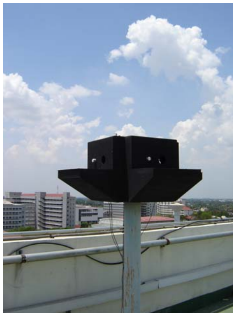
รูปที่ 3.12 แสดงอุปกรณ์วัดวัด global illuminance บนระนาบแนวตั้ง 4 ทิศ ที่มหาวิทยาลัย ศิลปากร จังหวัดนครปฐม
