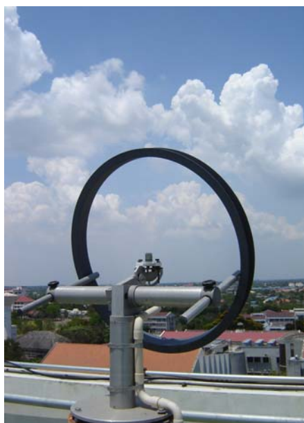
รูปที่ 3.13 แสดงอุปกรณ์วัดวัด diffuse illuminance บนพื้นราบ ที่มหาวิทยาลัยศิลปากร จังหวัดนครปฐม
