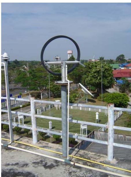
รูปที่ 3.11 แสดงอุปกรณ์วัด diffuse illuminance บนพื้นราบ ที่ศูนย์อุตุนิยมวิทยาภาค ตะวันออกเฉียงเหนือ จังหวัดอุบลราชธานี
