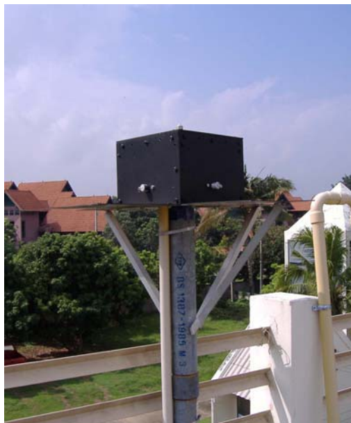
รูปที่ 3.6 แสดงอุปกรณ์วัด global illuminance บนระนาบแนวตั้ง 4 ทิศ ที่ศูนย์อุตุนิยมวิทยา ภาคเหนือจังหวัดเชียงใหม่
