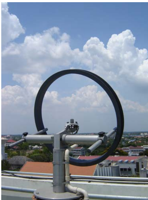
รูปที่ 3.2 แสดงอุปกรณ์วัด diffuse illuminance บนพื้นราบ
