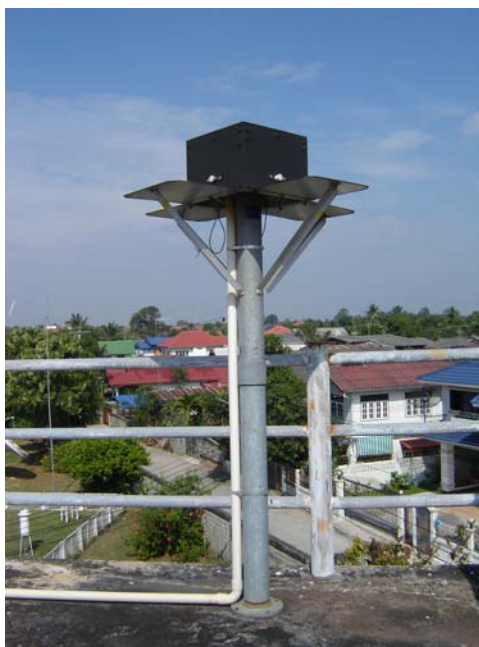
รูปที่ 3.9 แสดงอุปกรณ์วัด global illuminance บนระนาบแนวตั้ง 4 ทิศ ที่ศูนย์อุตุนิยมวิทยา ภาคตะวันออกเฉียงเหนือ จังหวัดอุบลราชธานี
