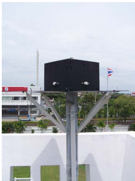
รูปที่ 3.15 แสดงอุปกรณ์วัด global illuminance บนระนาบแนวตั้ง 4 ทิศ ที่ศูนย์อุตุนิยมวิทยา ภาคใต้ฝั่งตะวันออก จังหวัดสงขลา
