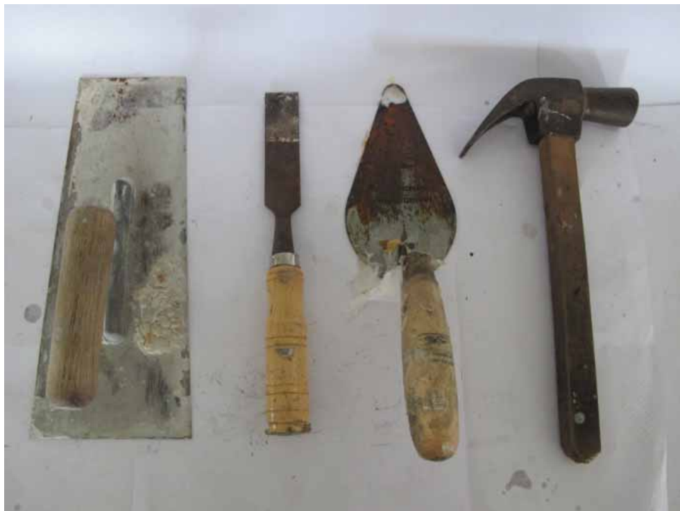
ภาพที่ 23 : เครื่องมือที่ใช้ในการทำพื้นปูนซีเมนต์
