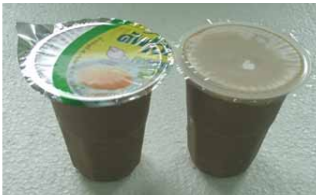
ภาพผนวกที่ 6 ซ้าย กาแฟพร้อมดื่มบรรจุด้วยพลาสติกชนิดโพลีสไตรีน (polystyrene) ปิดผนึกด้วยแผ่นฟิล์มเมทัลไลซ์ (metallize) ขวา กาแฟพร้อมดื่มบรรจุด้วยพลาสติกชนิดโพลีสไตรีน (polystyrene) ปิดผนึกด้วยแผ่นฟิล์มพลาสติกลามิเนต (plastic laminate)
