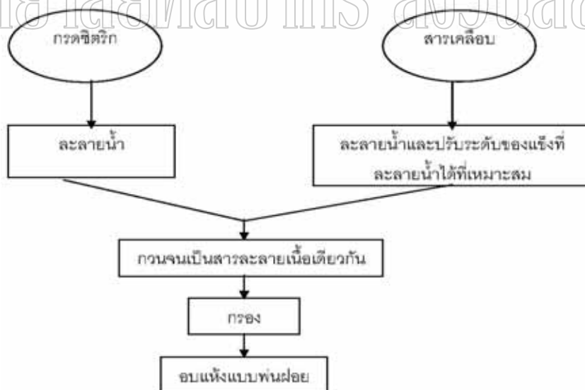
ภาพที่ 6 ขั้นตอนการทำเอ็นแคปซูลของกรดซัคคิวไรคโดยการทำแห้งแบบพ่นฝอย
