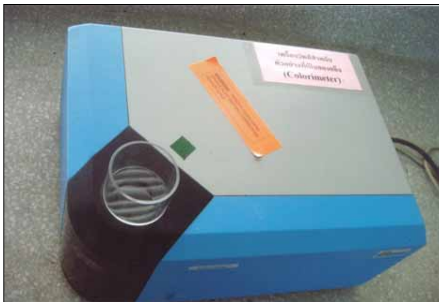
รูปผนวกที่ จ-5 เครื่องวัดสี (colorimeter, Color-view™ spectrophotometer, Model 9000, USA.)
