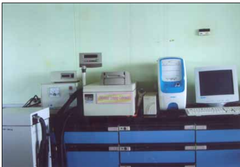
รูปผนวกที่ จ-9 เครื่องวิเคราะห์การเปลี่ยนแปลงเชิงความร้อน (Differential Scanning Calorimeter, DSC, Pyris 1, USA.)
