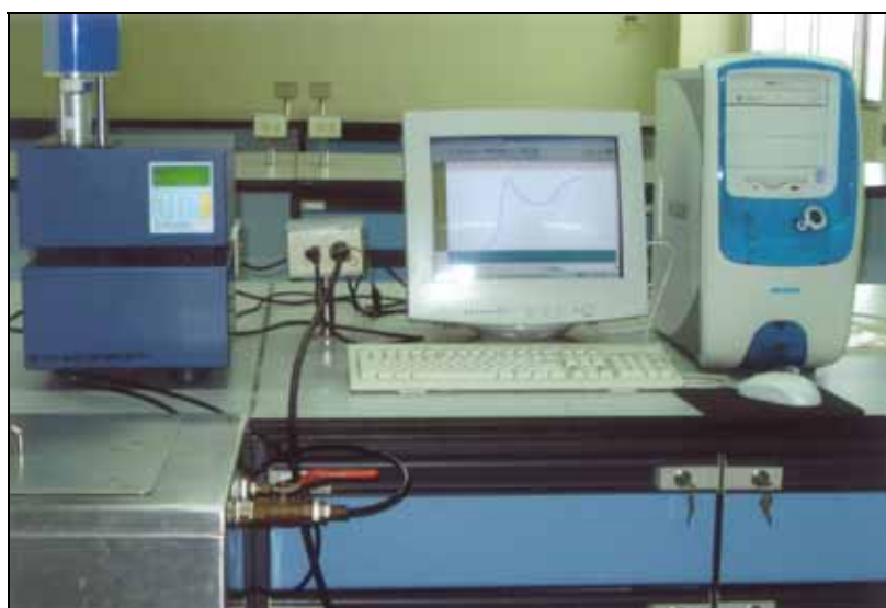
รูปผนวกที่ จ-4 เครื่องวัดความหนืดแบบรวดเร็ว (Rapid Visco Analyser, RVA, Newport Scientific, Model RVA-4, Australia)
