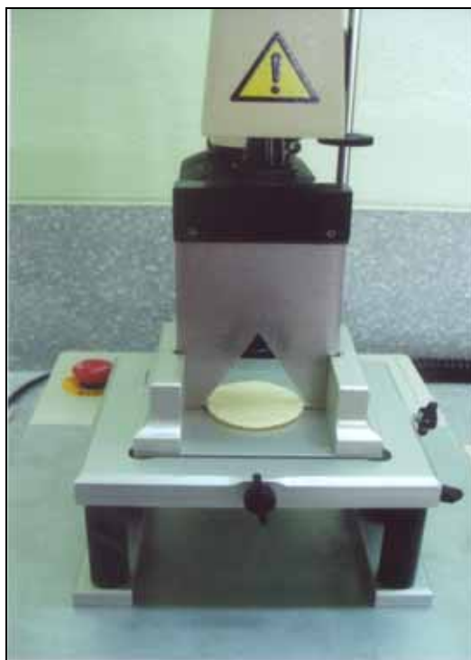
รูปผนวกที่ จ-11 หัววัดเนื้อสัมผัส (base set with Warner Brazer probe)
