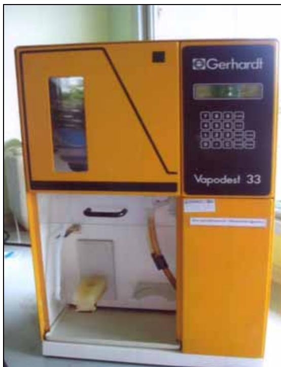
รูปผนวกที่ จ-7 ชุดวิเคราะห์โปรตีน (distillation unit, Gerhardt, VAP 33, Germany)
