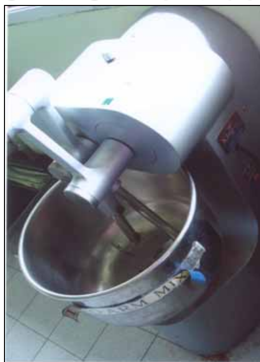
รูปผนวกที่ จ-12 เครื่องนวดสองแขน (two-arm mixer, King Machines, Thailand)
