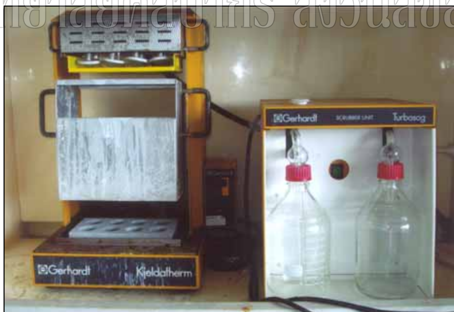
รูปผนวกที่ จ-6 เครื่องย่อยโปรตีน (digestion block, Gerhardt Kjeldatherm, Type TR, Germany)
